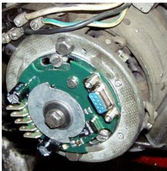
3. Utažení stínítka s natočením na předstih 28^\circ dle typu motoru ( 26-30^\circ )
